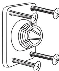
**Paso 4.** Separe la arandela (C) de la pieza de soporte principal (A).
